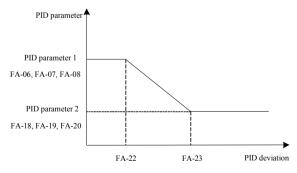
Fig.5-23 PID parameter switching
